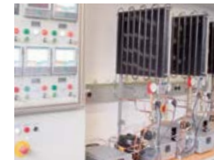
Испытательный компрессорный стенд
