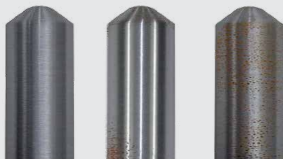
проходит RENOLIN PA 220 умеренная коррозия сильная коррозия
